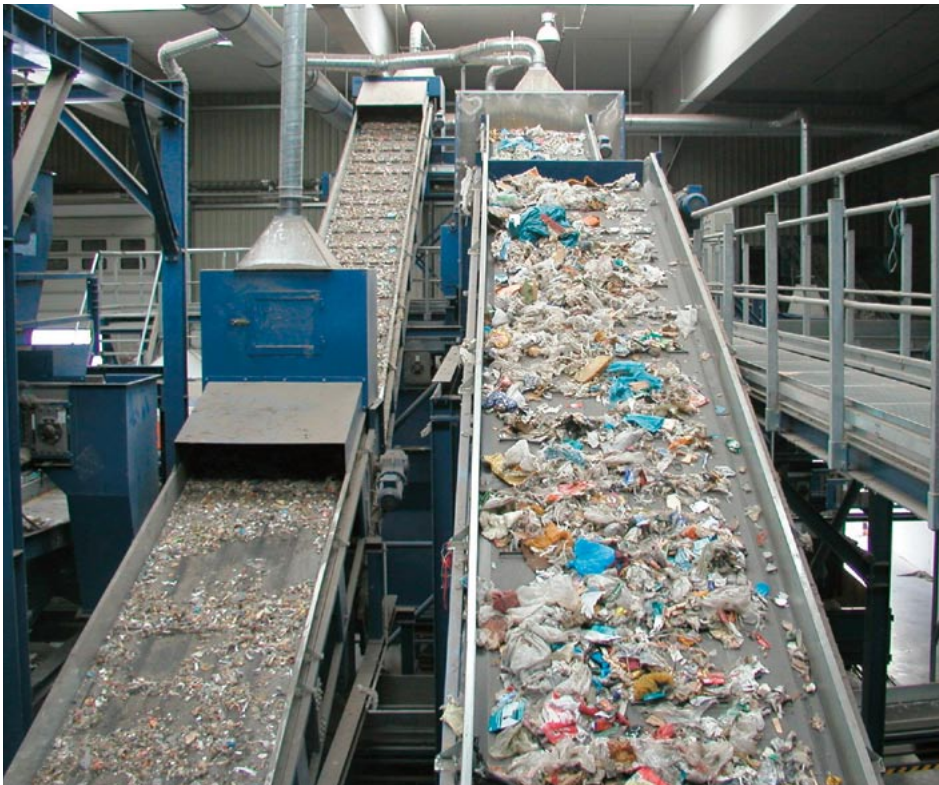
Ersatzbrennstoffe bestehen z.B. aus Papier, Holz und Kunststoffen, die aus dem Haus- und Gewerbemüll aussortiert werden und dann für die Energieversorgung genutzt werden können.
