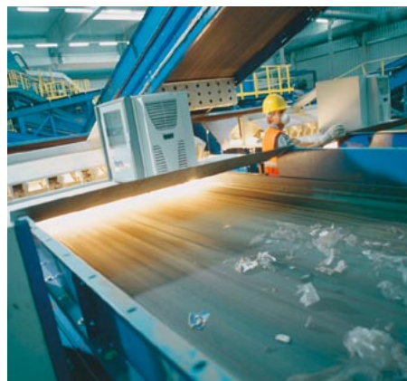
Durch hochmoderne Sortierverfahren wie die Nahinfrarottechnik können aus gewöhnlichem Haus- und Gewerbemüll wertvolle Ersatzbrennstoffe gewonnen werden.
